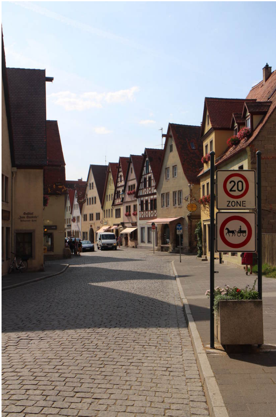
Abbildung 2.2 Beginn eines Verkehrsberuhigten Geschäftsbereich mit Tempo 20 in Rothenburg ob der Tauber. Unten ein Zeichen Verbot für Pferdefuhrwerke (wird nur sehr selten verwendet; hier in Rothenburg ob der Tauber wohl relevant aufgrund touristischer Pferdefuhrwerke). Bild: Dirk Schmidt 07-2015
