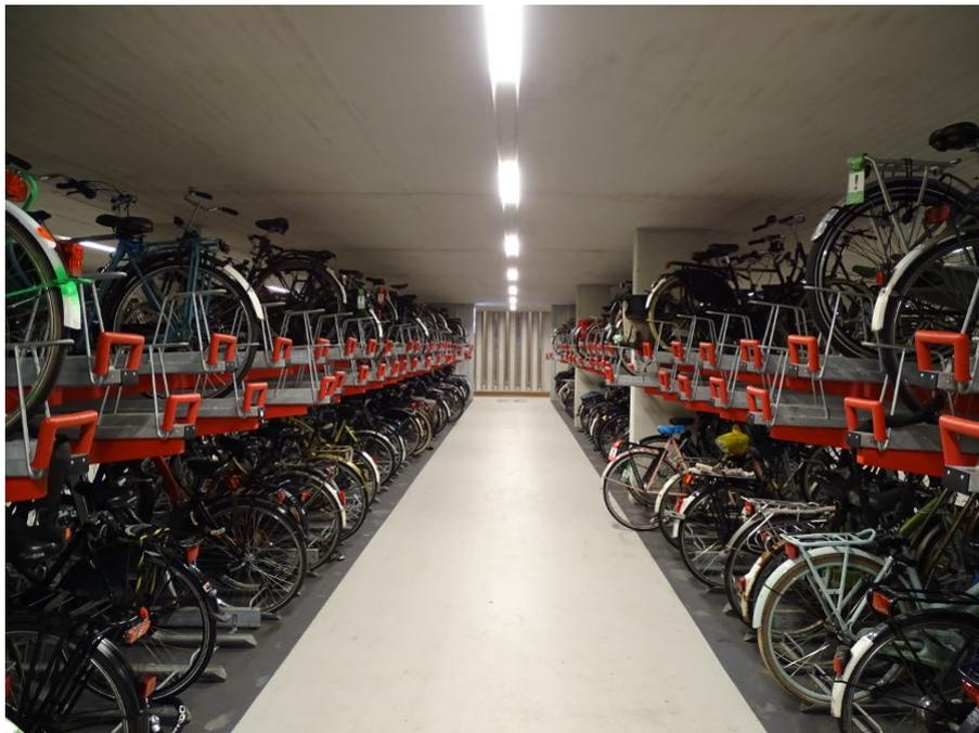
**Abbildung 5.21** Fahrradparkhaus Utrecht: Blick auf die klassischen Doppelparker, die in vielen niederländischen Fahrradparkhäusern zu finden sind. Das Rad lässt sich dank einer Gasdruck-Federmechanik auch oben relativ unkompliziert einparken. Bild: Swen Schneider 10-2019
