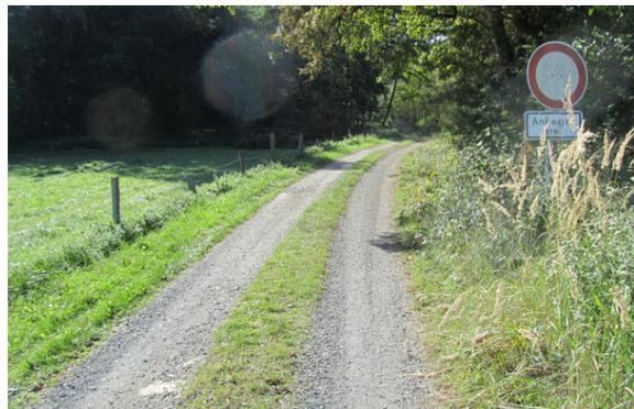
Bild 2: Zusatzzeichen 1022-10 unter der bestehenden Wegwidmung ergänzen. Oder alternativ Zeichen 250 durch Zeichen 260 ersetzen.
