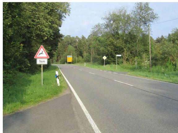
Bild 2: Gefährliche, uneinsichtige Querung der B251 mit eingeschränktem Sichtfeld. Geschwindigkeitsreduzierung auf Tempo 70 + Z. 138 "Radfahrer kreuzen" notwendig.
