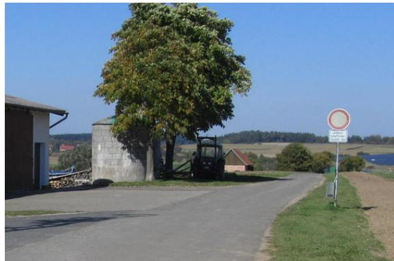
Bild 2: Zusatzzeichen 1022-10 unter der bestehenden Wegwidmung ergänzen. Oder alternativ Zeichen 250 durch Zeichen 260 ersetzen.
