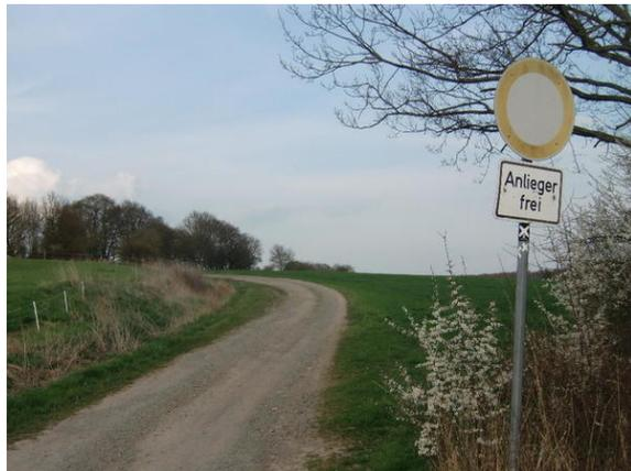
Bild 3: Zusatzzeichen 1022-10 unter der bestehenden Wegwidmung ergänzen. Oder alternativ Zeichen 250 durch Zeichen 260 ersetzen.
